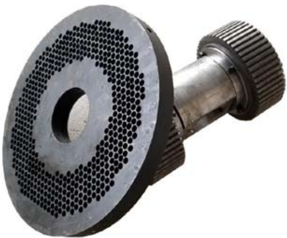
شکل ۱- نحوه عملکرد دای در دستگاه پلت
